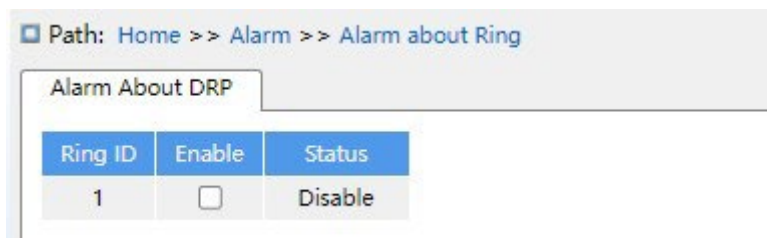
Рисунок 85 Настройка аварийной сигнализация по кольцу
